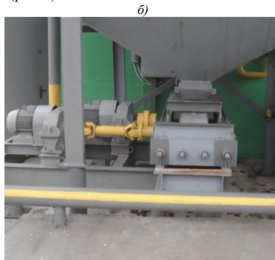
Рис. 4. ПВИ с устройством для дезагломерации спрессованных материалов: а – конструктивная схема установки: 1 – бункер; 2 – основные конические валки; 3 – валки дополнительные; б – фото опытно промышленного агрегата
