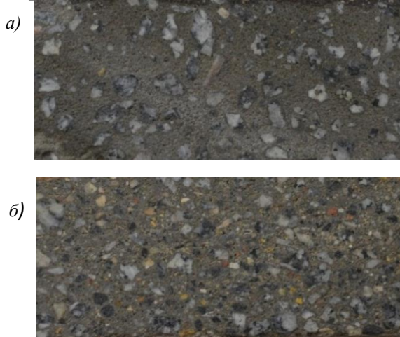
Рис. 8. Образцы вибропрессованных плит тротуарных контрольного состава (а) и разработанного состава (б)
