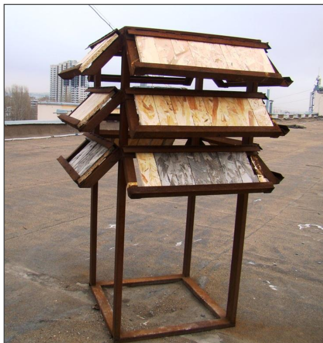
Рис. 1. Стенд для испытания образцов на атмосферостойкость
