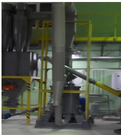
Рис. 5. Фото опытно-промышленной роторно-вихревой мельницы
